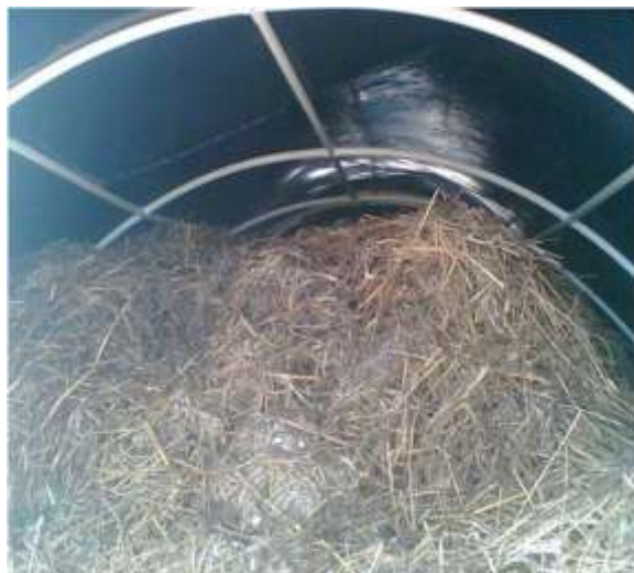
Fot. 2. Pryzma obornika pod tunelem przed pomiarem emisji metodą „aerodynamic tunnel” (widok zewnętrzny tunelu) (fot. Jacek Walczak).
