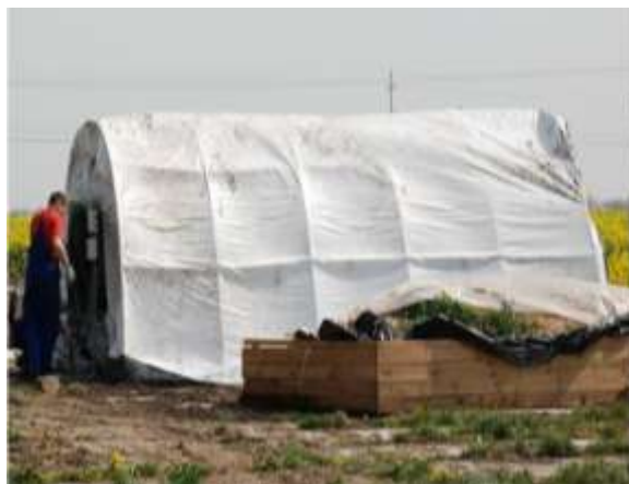
Fot. 2. Pryzma obornika pod tunelem przed pomiarem emisji metodą „aerodynamic tunnel” (widok zewnętrzny tunelu) (fot. Jacek Walczak).
