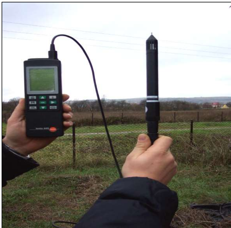
Fot. 7. Monitoring mikroklimatu elektronicznym miernikiem Testosterm, Testo 9610 (fot. Jacek Walczak).
