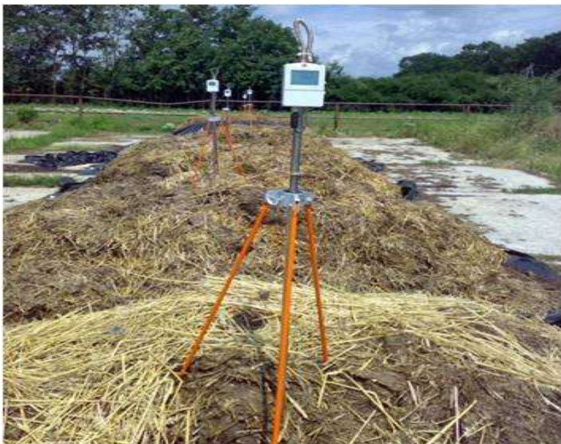
Fot. 3. Pomiary temperatury przyżm sondami termicznymi prototypowa aparatura wyposażona we własne zasilanie i Data Logger (fot. Jacek Walczak).
